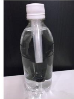
図2 超過飽和水素水の装置。水素発生剤を含む不織布を水で湿らせアクリル樹脂製のチューブに挿入し、ペットボトルにチューブを挿入した。チューブ内で発生した水素ガスは、逆止弁を介してペットボトル内に送られた。
